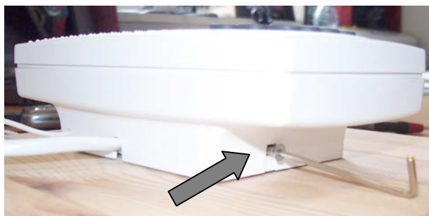
Abb. 3: Festsetzen des Acomfort auf die Wandhalterung (die Klammern stecken im Gehäuse und sind nicht sichtbar)
